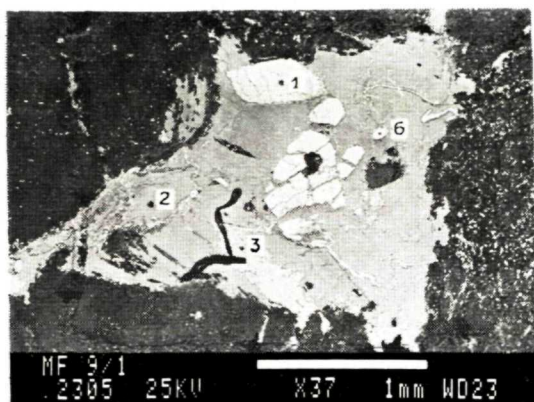
Obr. 5. Alotriomorfny chloritizovaný biotit so zložením v bode 2: \text{SiO}_2 27,53, \text{Al}_2\text{O}_3 19,14, \text{Na}_2\text{O} 0,04, \text{CaO} 0,03, \text{MgO} 17,52, \text{FeO} 20,95, \text{TiO}_2 0,02, \text{K}_2\text{O} 0,17 %. V spodnej časti je epidotizovaný. Zloženie epidotu v bode 3: \text{SiO}_2 36,83, \text{Al}_2\text{O}_3 21,69, \text{CaO} 23,82, \text{MgO} 0,06, \text{FeO} 12,74, \text{TiO}_2 0,05 %. Biotit obsahuje uzavreniny apatitu II, ktorého zloženie v bode 1 je: \text{SiO}_2 0,00, \text{CaO} 54,78, \text{FeO} 0,02, \text{ZnO} 0,12 ( \text{P}_2\text{O}_5 sa na mikrosonde neanalyzuje), a zirkón (bod 6). V okolí je plagioklas bazicity \text{Ab}_{68}\text{An}_{31}\text{Or}_1 . Fig. 5. Anhedral chloritized biotite (point No 3) altered into epidote in the lower part. Apatite II inclusions in biotite. Plagioclase of \text{Ab}_{68}\text{An}_{31}\text{Or}_1 composition in the surroundings
